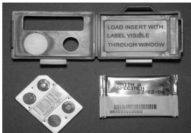
Mynd 1. TLD-geislaælihyllki (opíð efst), TLD-æliplata (t.v.) og innpökkuð (og áletruð) æliplata (neðst t.h.)
