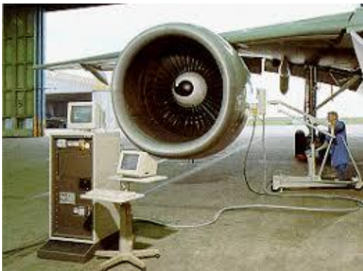
Mynd 3. Dæmi um röntgentæki við myndatöku í flugiðnaði.
